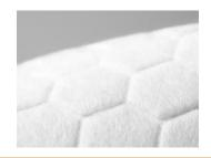
Interface: trame enduite d'une substance neutre (silicone par ex)
